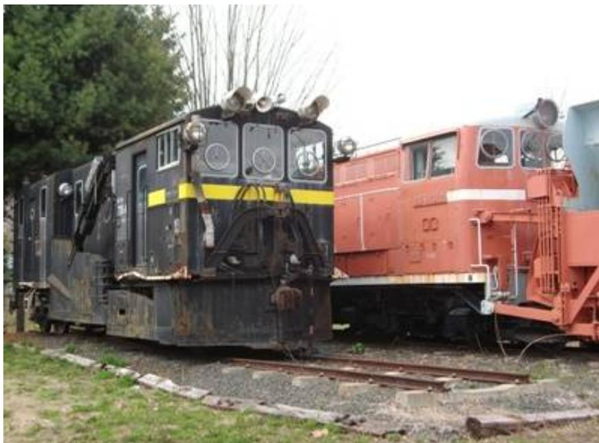
1 主に操車場等広い場所を効率よく除雪するための除雪車。アメリカから導入された車両を基に国産化された。車体側面の左右に、ラッセル式雪かき車よりもはるかに長い主翼を持ち、最大7メートル幅まで一度に除雪することができた。機動力のあるディーゼル除雪用機関車やハイモ(排雪モーターカー)に押されて、次第に出番が少なくなっていった。
