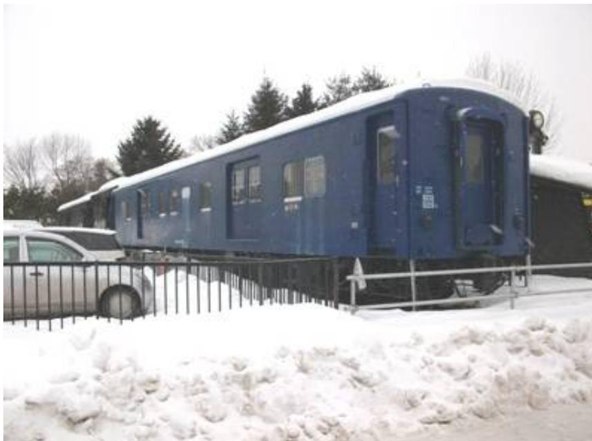
1 郵便物のみを輸送する目的で製作された車両。乗客が乗る部屋や、国鉄が取り扱っていた手荷物(チッキ)、小荷物を積載する部屋は車両の中には無い。郵便物のみを取り扱う車両は郵政省(当時)が所有していた。一方、車両の中に荷物や乗客の部屋と一緒に郵便物の部屋がある車両は、合造車と呼ばれ国鉄所有であった。
