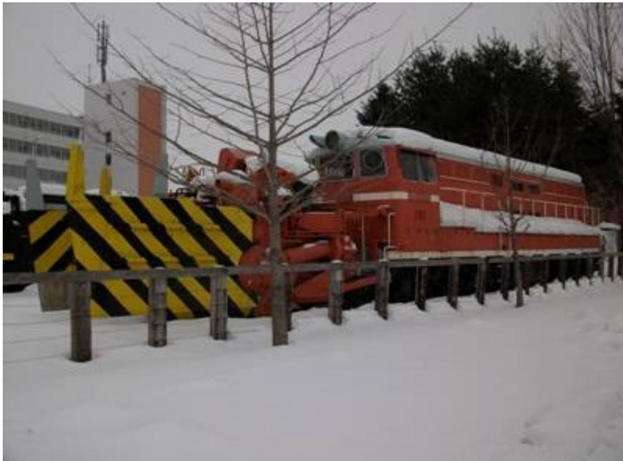
1 北海道をはじめとする豪雪地帯の除雪用として開発された機関車。従来、動力を持たない除雪車を蒸気機関車で推進させることで行っていた線路の除雪を、ディーゼル機関車自らの動力で、機関車そのものと機関車と直結した投雪装置(ロータリーヘッド)を動かすことで、除雪性能のアップと除雪作業の合理化が図られるようになった。
